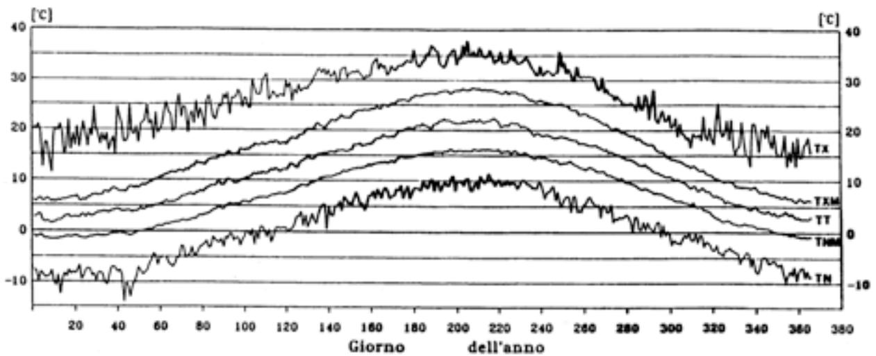
**Figura 3** – Il diagramma in alto presenta per i 365 giorni dell'anno (in ascissa) le temperature medie ed estreme per la stazione di Pristina - Kosovo (periodo di riferimento 1977-1991) e per quella di Lugano - CH (periodo di riferimento 1901-1990 - fonte: MeteoSvizzera). I due diagrammi riportano dall'alto verso il basso le seguenti linee: massima assoluta, media delle massime, media delle medie, media delle minime e minima assoluta).
