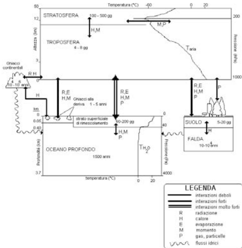
**Figura 12** – il sistema climatico, i principali sottosistemi che lo compongono e gli scambi (di materia, energia, momento, ecc.) in atto fra essi. In due casi (troposfera e strato di rimescolamento oceanico) la scala dei tempi rappresenta il tempo occorrente per ridurre i coefficienti di autocorrelazione al di sotto della soglia di significatività mentre negli altri casi rappresenta il tempo di permanenza delle sostanze caratteristiche (da Flohn e Fantechi, 1984 - modificato).
